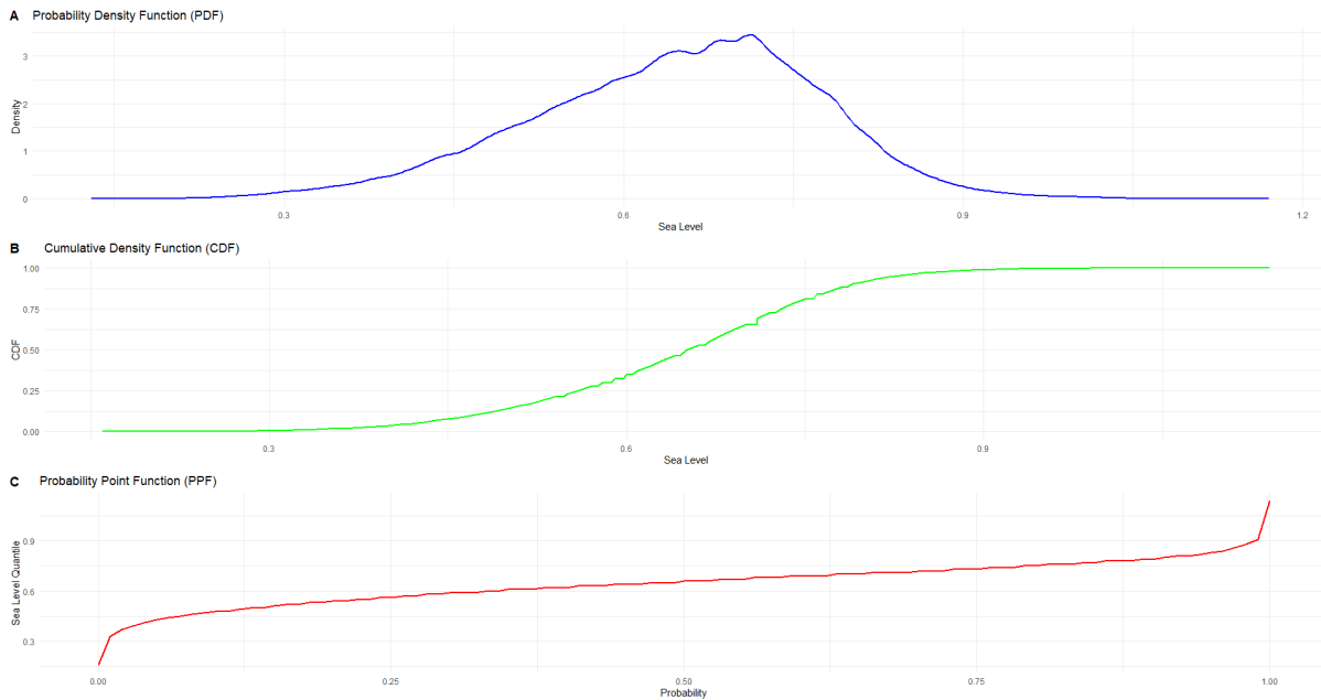
Σχήμα 4.86. Οι PDF: Συνάρτηση πυκνότητας πιθανότητας (μπλε καμπύλη), CDF Συνάρτηση αθροιστικής πυκνότητας (πράσινη καμπύλη), PPF: Συνάρτηση σημείου πιθανότητας (κόκκινη καμπύλη). για τα έτη των καταγραφών 1998 – 2023.
